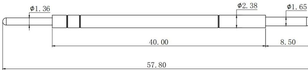
Schaltstifte eignen sich für viele verschiedene Anwendungen: Sie können nicht nur für Bauteilerkennungstests, Schalter für geschlossene/offene Kontrollen, sondern auch als Signalauslöser für die Prozesskontrolle verwendet werden. Darüber hinaus ist in Kombination mit anderen Prüfspitzen (z. B. Push-Back-Stiften) eine Positionsbestimmung von Kontaktanschlüssen in Steckergehäusen möglich.
