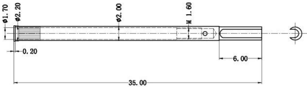
**Kabelbaum-Prüfspitze mit Gewindeschraubentestgerät:**
