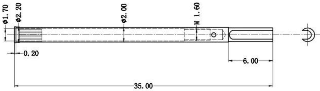
Sonda de prueba de haz de cables con equipo de prueba de tornillo de rosca:
