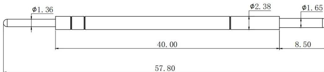
Le sonde di commutazione sono adatte a molte applicazioni diverse: non solo possono essere utilizzate per test di rilevamento di componenti, interruttori per controlli chiusi/aperti, ma anche come trigger di segnale per il controllo di processo. Inoltre, in combinazione con altre sonde di prova (ad es. sonde push-back), è possibile determinare la posizione dei terminali di contatto negli alloggiamenti dei connettori.
