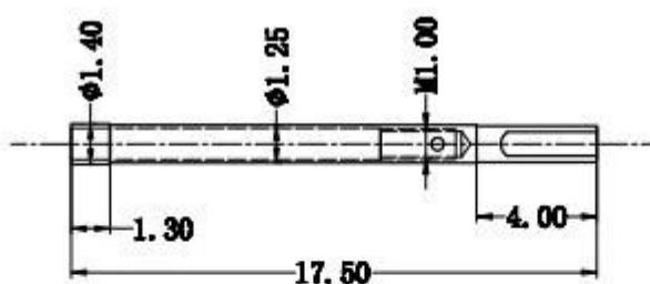
材质：针头铍铜 针管黄铜 套管黄铜
